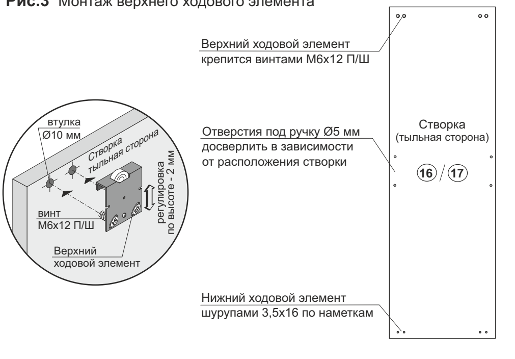
Рис.3 Монтаж верхнего ходового элемента
