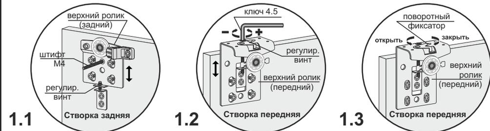
**Рис.2** Сборка створки (Вид с тыльной стороны)
