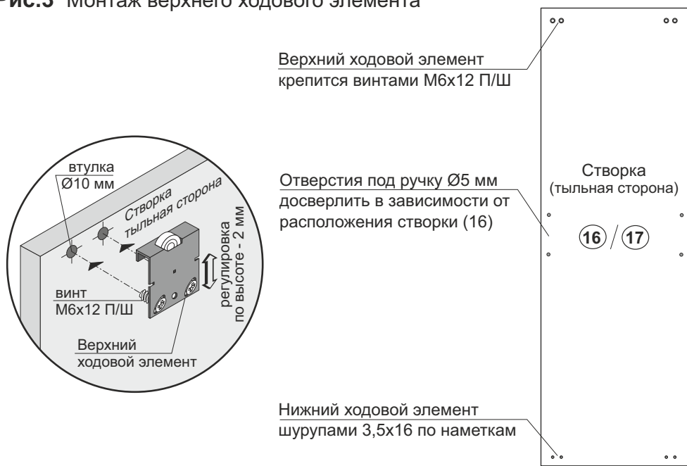
Рис.3 Монтаж верхнего ходового элемента
