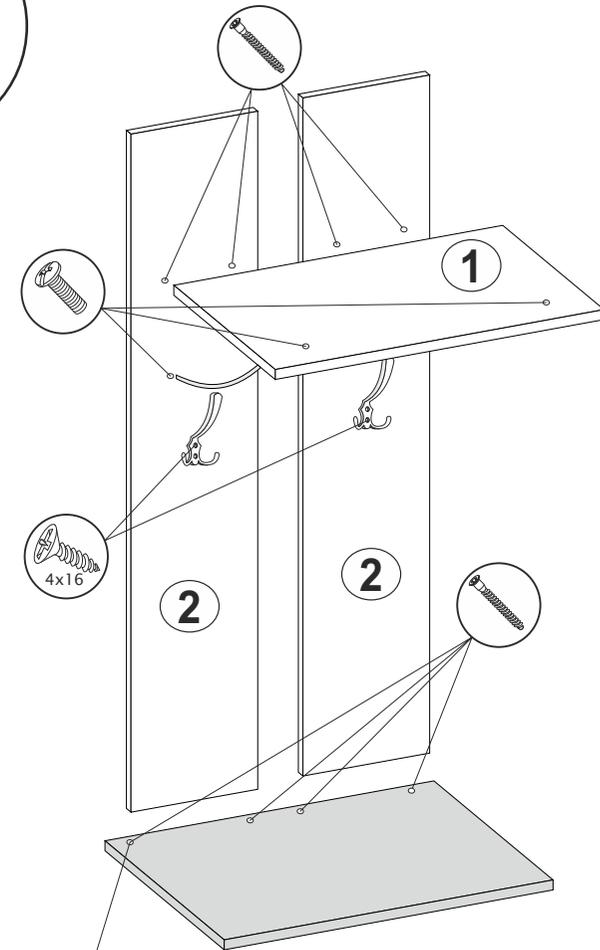
Досверлить в крыше обувницы отверстия диаметром 8 мм.
