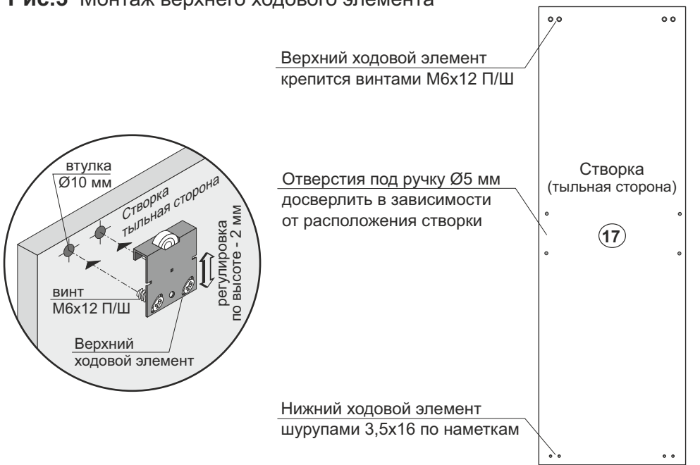
Рис.3 Монтаж верхнего ходового элемента
