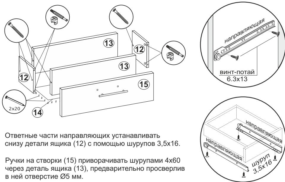
Рис.7 Сборка выдвижного ящика
